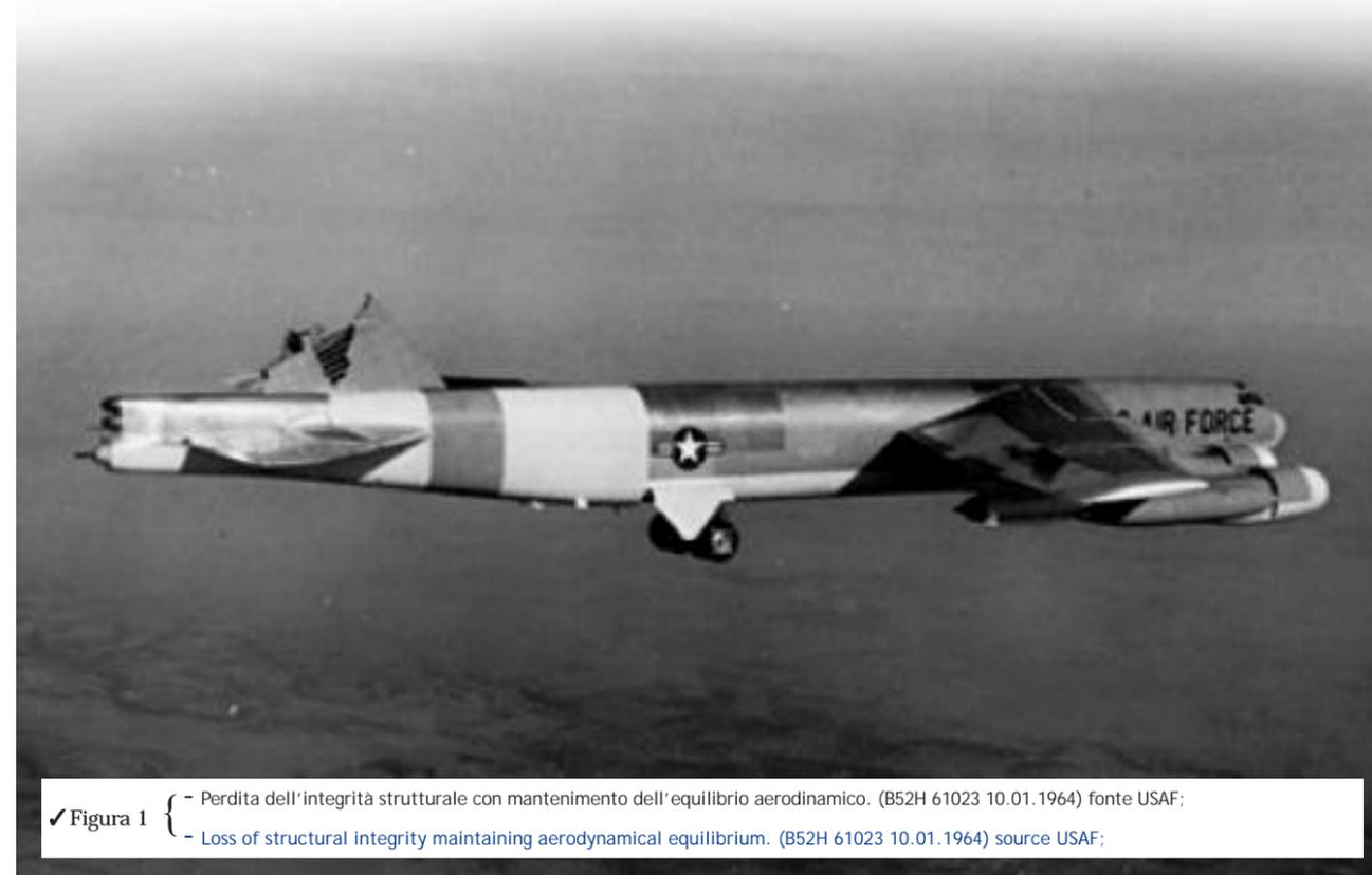
✓ Figura 1 { - Perdita dell’integrità strutturale con mantenimento dell’equilibrio aerodinamico. (B52H 61023 10.01.1964) fonte USAF;
